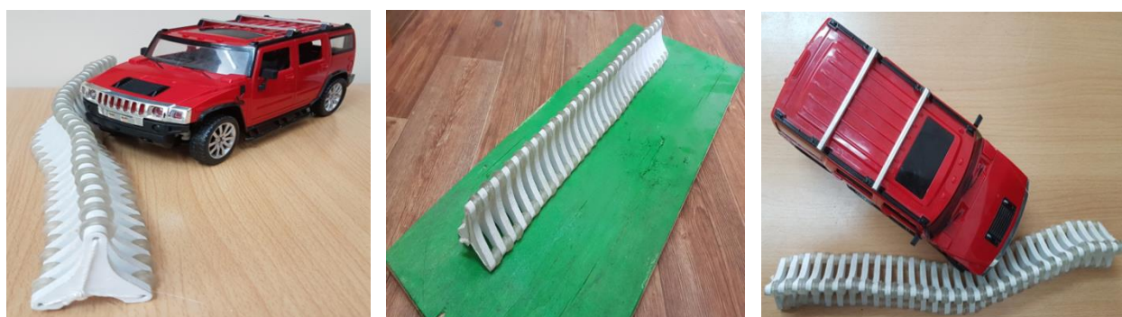
Рисунок 2 – Взаимодействия автотранспорта с подвижными элементами барьера безопасности (макет)
